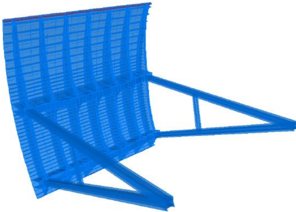
Figura 3.8 Modelo tridimensional del refuerzo de las compuertas
