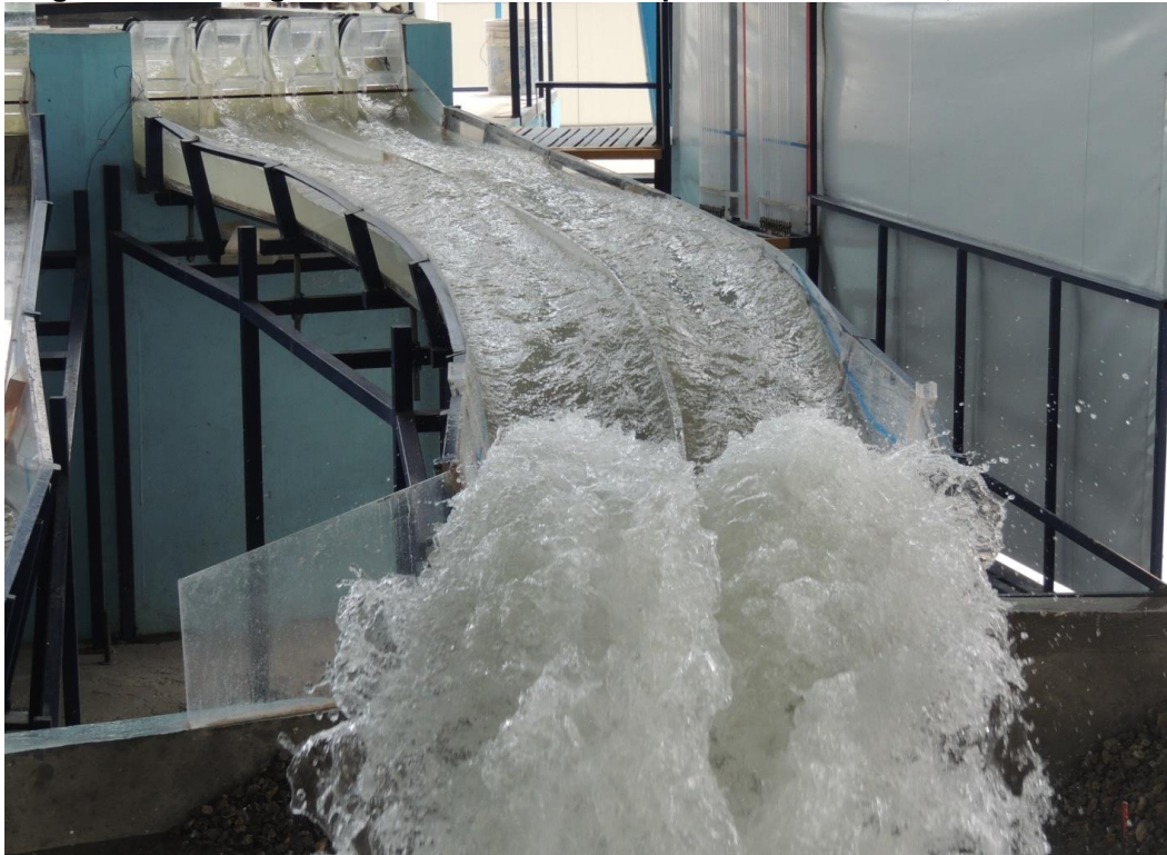
Figura 3.41 Modelo físico del vertedor de emergencia, Q=9\ 400\ m^3/s .
