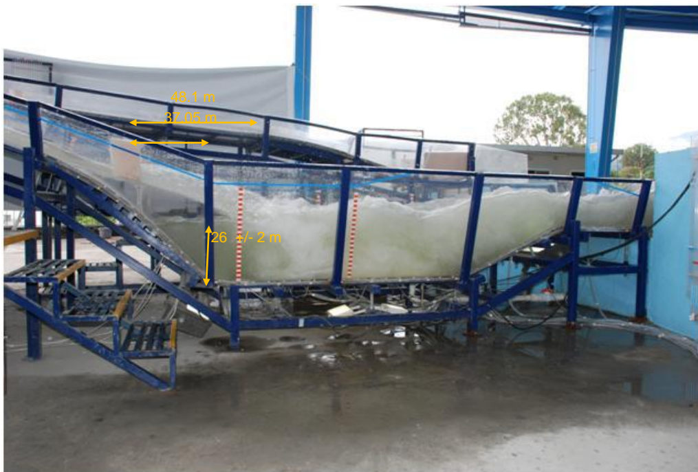
Figura 3.34 Perfil del flujo en el tanque amortiguador, Q=7\ 000\ \text{m}^3/\text{s}
