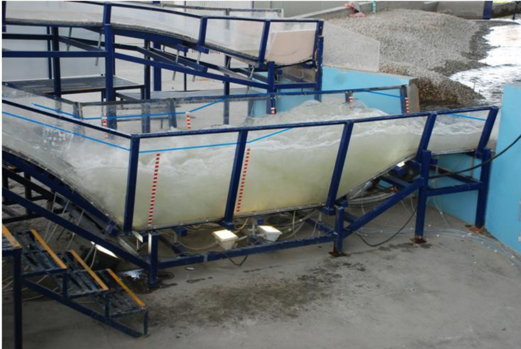
Figura 3.30 Funcionamiento del tanque amortiguador, Q=7\ 000\ \text{m}^3/\text{s}
