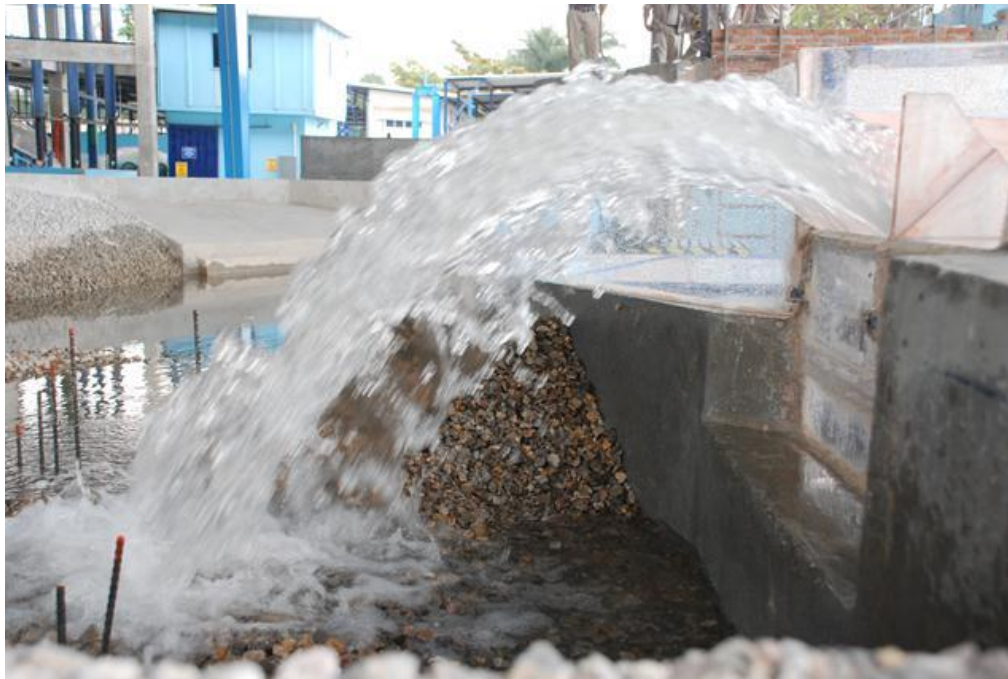
Figura 3.38 Gasto de despegue del labio de la cubeta, canal derecho
