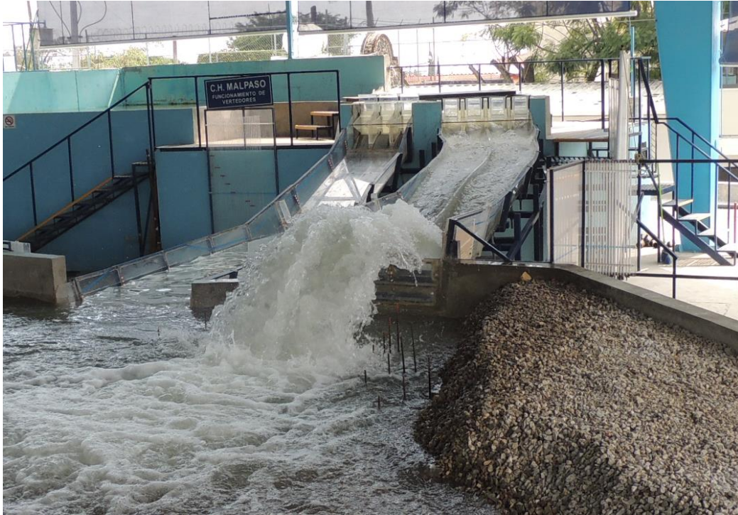
Figura 3.40 Vista general del funcionamiento para ambos canales, Q=9\ 400\ m^3/s .
