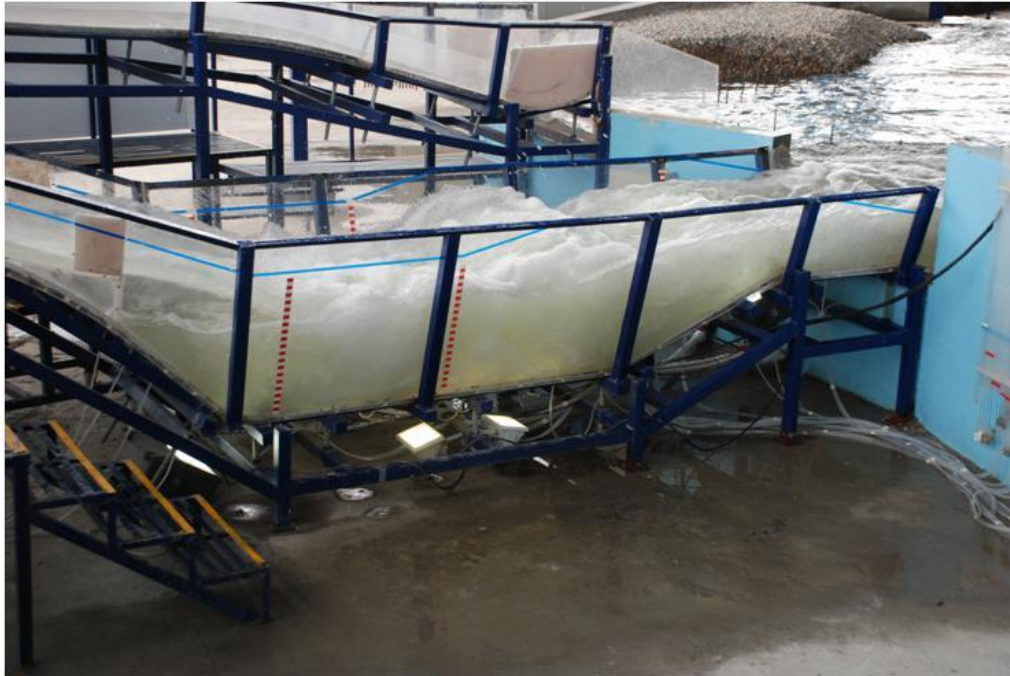
Figura 3.33 Funcionamiento del tanque amortiguador, Q=7\ 000\ \text{m}^3/\text{s}
