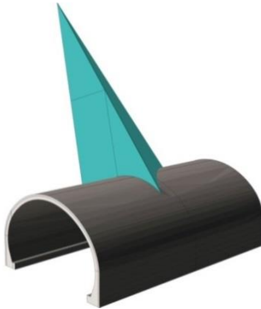
Figura 3.4. Geometría de la cuña máxima para análisis. Tomada de Proyecto Túnel Acapulco (Consultec).
