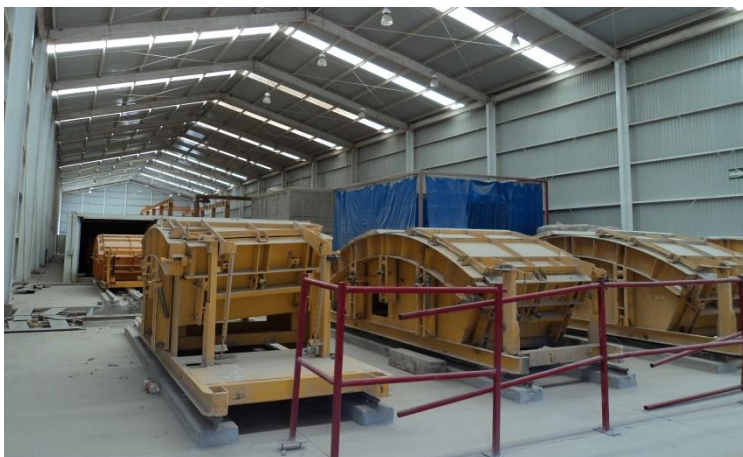
Figura 5.9 Fabricación de dovelas.
