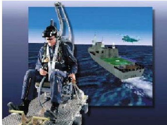
Figura 3.1: Un casco de realidad virtual (Head Mounted Display) permite un mayor de sentido inmersión al usuario. [M4]
