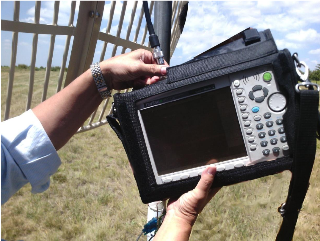
Figura 6.9 Analizador de espectros conectado a la antena parabólica ubicada en Tecamac, con la finalidad de medir la potencia de recepción
