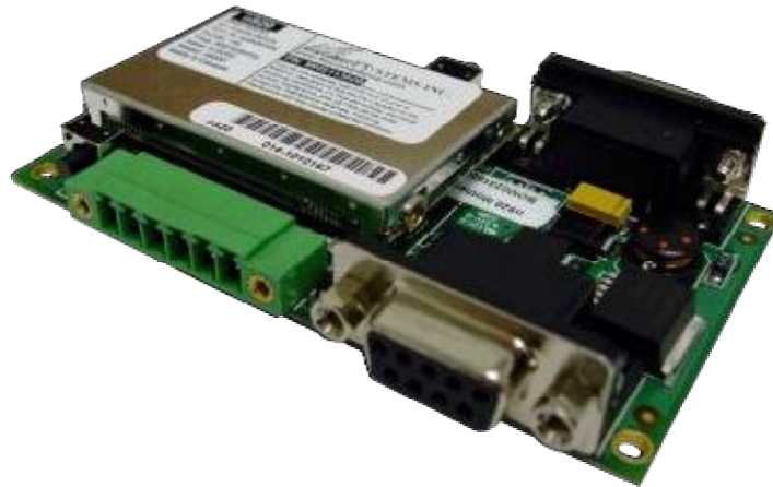
Figura 3.5 Radio Banda S de Microhard, modelo n2420 montado en tarjeta de desarrollo nano motherboard [14]
