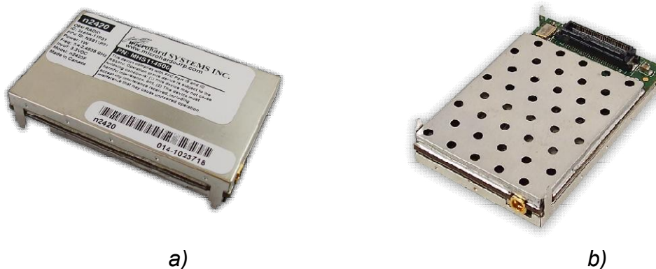
Figura 4.1 Modem comercial n2420 de Microhard Systems Inc [20] a) Vista frontal, b) Vista posterior donde podemos observar el conector AVX-Kyocera 5046 de 60 pines y el conector MMCX
