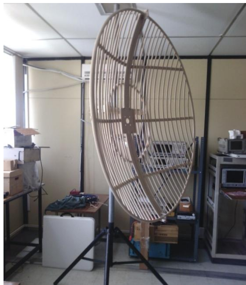
Figura 5.2 Antena parabólica para banda S utilizada realizar pruebas
