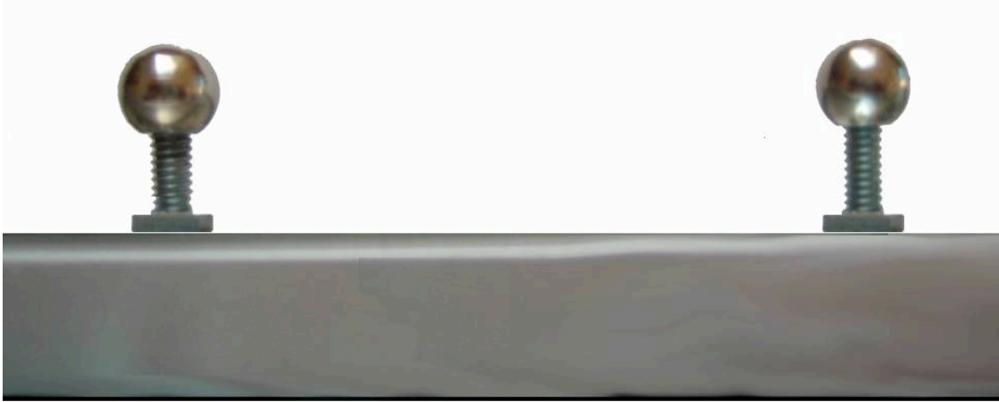
Figura 4.19 Vista lateral del riel mostrando los salientes del sistema de montaje.
