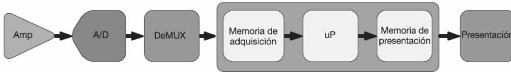
Figura 2.9. Arquitectura de procesado en serie de un osciloscopio digital DSO.
