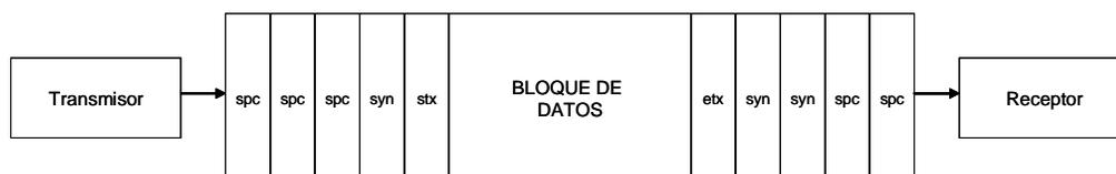
Fig. 2.6.2. Secuencia de transmisión de un bloque típico.
