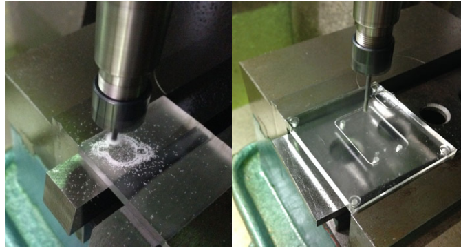
Figura 4 . 15 Fabricación de los soportes del prototipo de sistema mecánico
