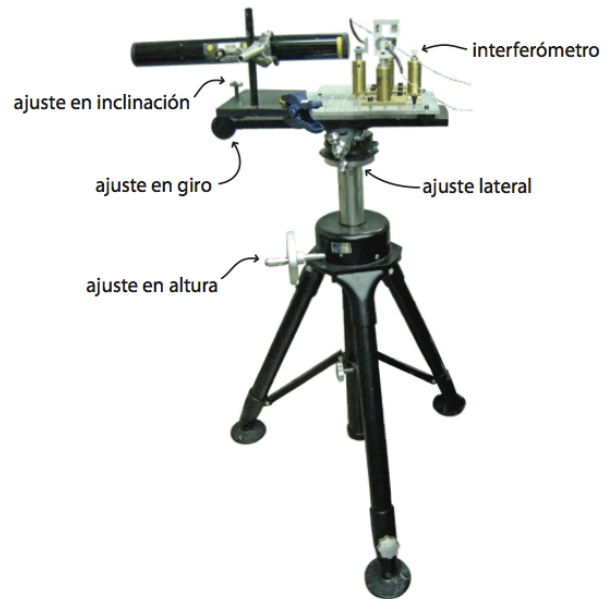
Figura 2 . 4 Interferómetro GMM 2011 alineado con la fuente láser en un trípode (Alagón, 2011)
