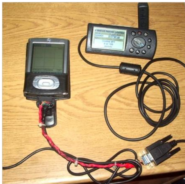
Figura 2.15. Conexión entre GPS y PDA.
