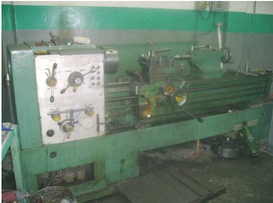
Figura 2.17. Torno horizontal a 220 V parte posterior de la nave.
