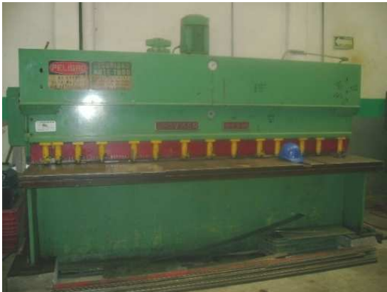
Figura 2.29. Cortadora de lámina con alimentación del centro de carga principal.
