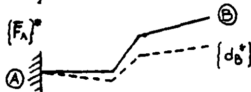
FIG. 6.- Barra \boxed{1} cargada y fuerzas de fijación \{\bar{F}_A\} y \{\bar{F}_B\}
