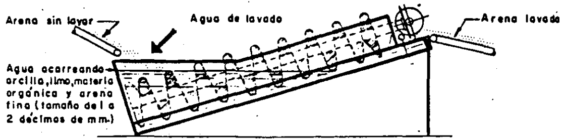
FIG. 42 CORTE ESQUEMATICO DE GUSANO LAVADOR
