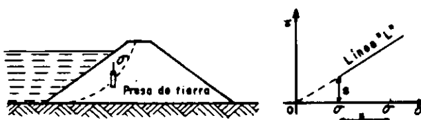
Figura 65. Obtención de la resistencia al esfuerzo cortante del suelo trabajando con esfuerzos efectivos.
