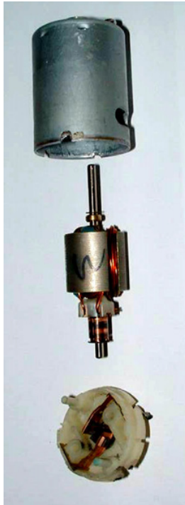
Fig. 3.14 Composición de un Motor con escobillas
