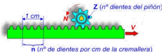
Fig.3.10 Relación de Velocidad Piñón-Cremallera
