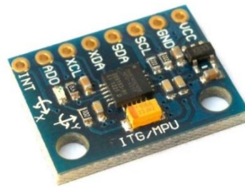
Figura 3.6: Sensor acelerómetro y giroscopio MPU-6050 [18]
