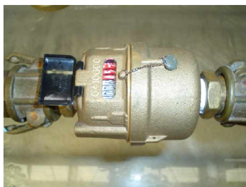
Ilustración A.1 Medidor volumétrico.
