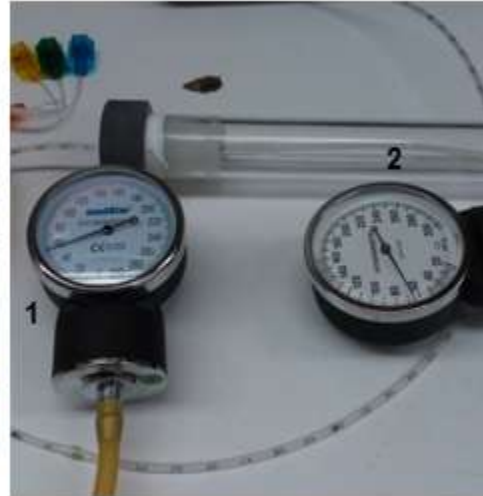
Fig. 4.21, Calibración del catéter. En la imagen de la derecha se observa que la magnitud de la presión del calibrador (2) y las microcámaras del catéter (1) no varía.
