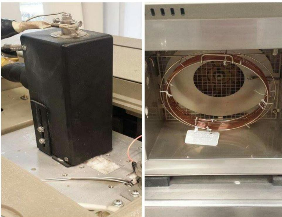
**Figura 4.8** Criofocus y columna del cromatógrafo de gases
