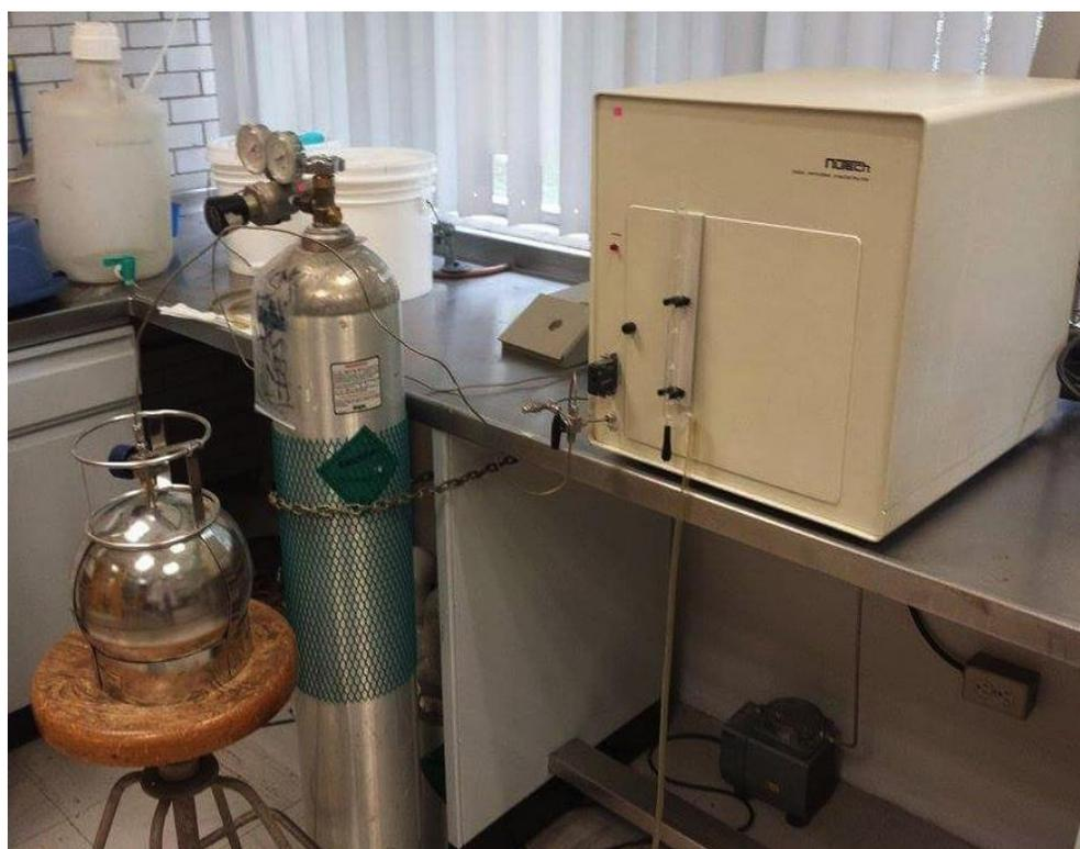
*Figura 4.6 Sistema de condensación criogénica*
