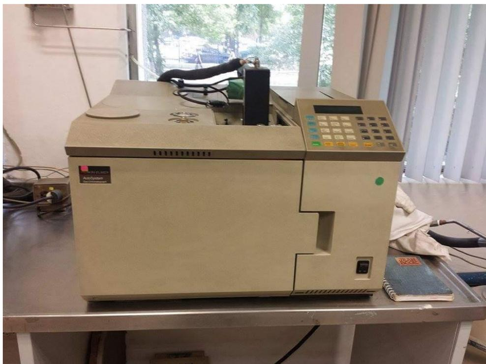
*Figura 4.7 Cromatógrafo de gases*
