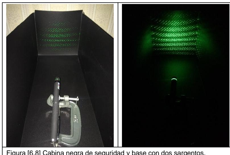
Figura [6.8] Cabina negra de seguridad y base con dos sargentos.
