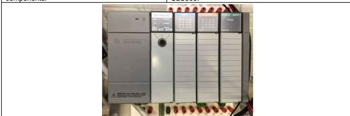
Figura [4.10] Equipo SLC 500 del laboratorio de PLC del CDMIT.
