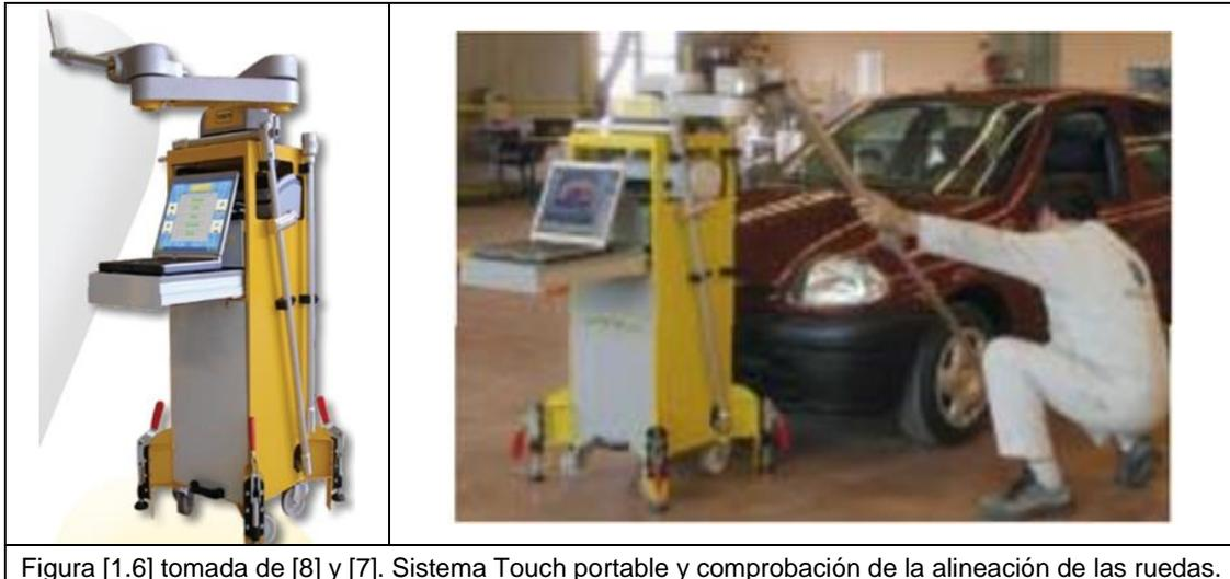
Figura [1.6] tomada de [8] y [7]. Sistema Touch portable y comprobación de la alineación de las ruedas.
