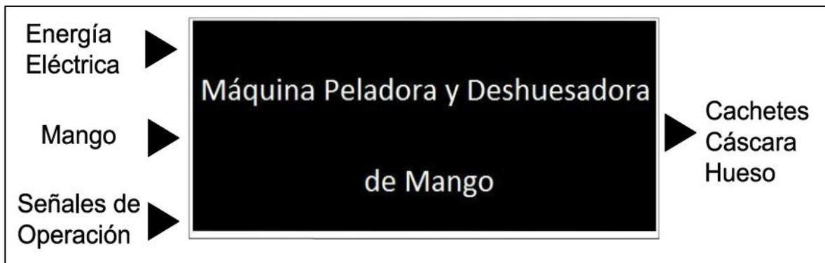
**Figura 4.1- Modelo de caja negra para la MPDM**
