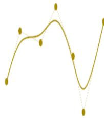
*Fig. B.1 Curva Bézier con 7 puntos de control*
