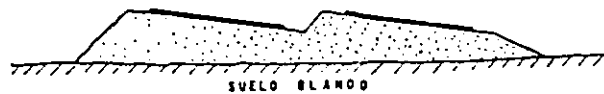
Figura VI-59. Terraplén en diente de sierra, apropiado para resolver problemas de sobre elevación por curva sobre suelos muy blandos.
