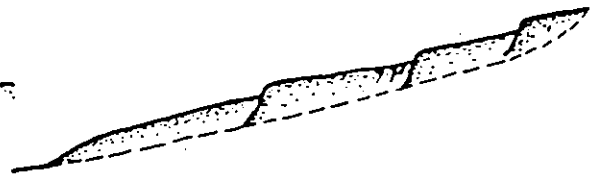
b) Falla regresiva traslacional.
