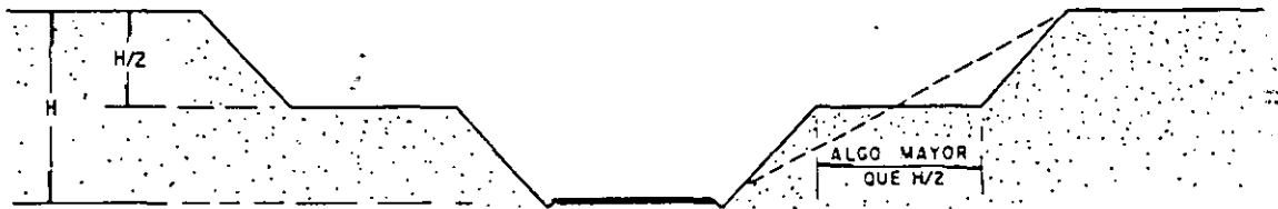
a). Escalonamiento en materiales cohesivos.
