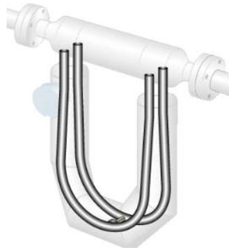
Figura 1.4. Tubo en U simulando oscilación
