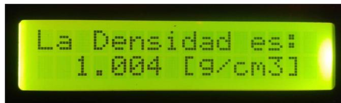
**Figura 5.15. Resultado de la medición de Densidad en pantalla LCD**
