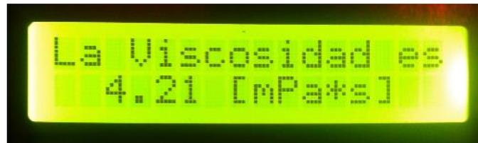
**Figura 5.11. Resultado de la medición de Viscosidad en pantalla LCD**
