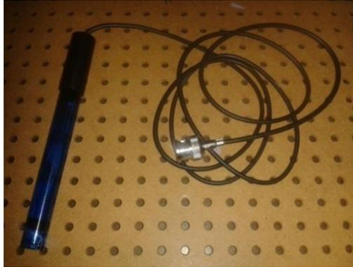
**Figura 3.15. Electrodo combinado de vidrio utilizado (OAKTON WD-35801-00)**
