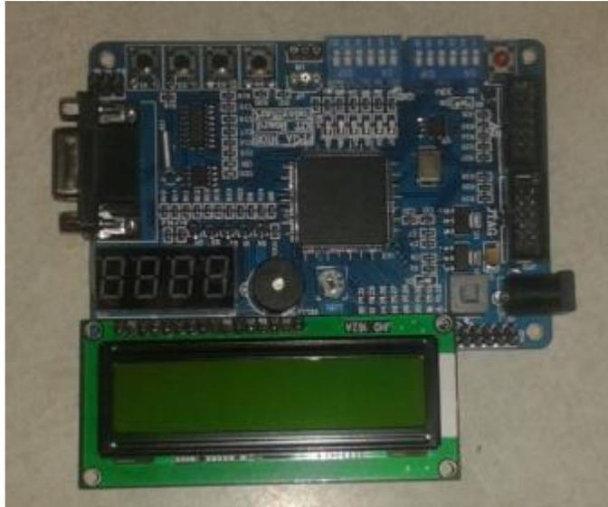
**Figura 4.9. Tarjeta de desarrollo de FPGA con Display.**
