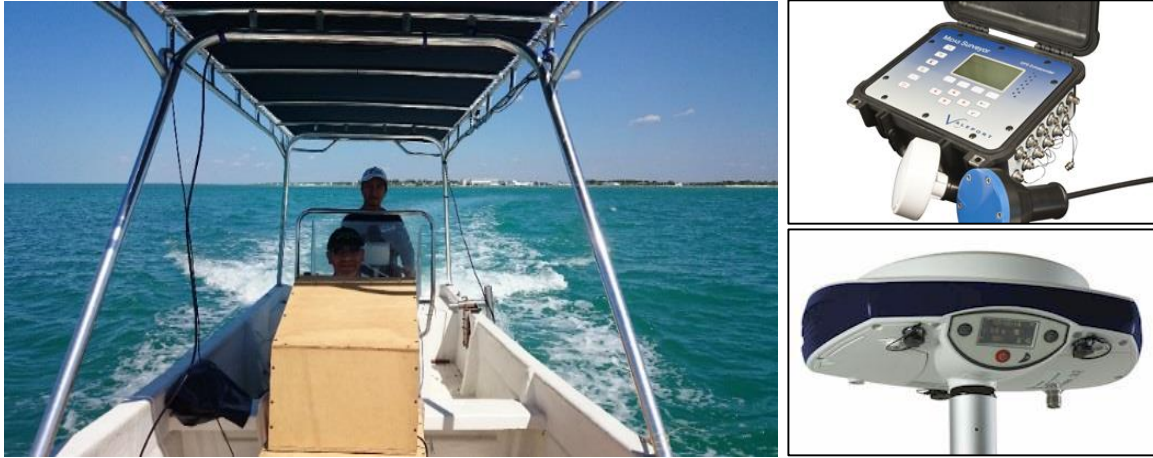
Figura 4-19. Salida a campo para levantamiento de datos de batimetría (izquierda), ecosonda (derecha superior) y GPS diferencial (derecha inferior) utilizados en los levantamientos de batimetría y topobatimetría.
