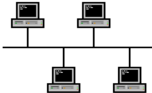
Figura 2.2.2 Topología de canal (BUS)
