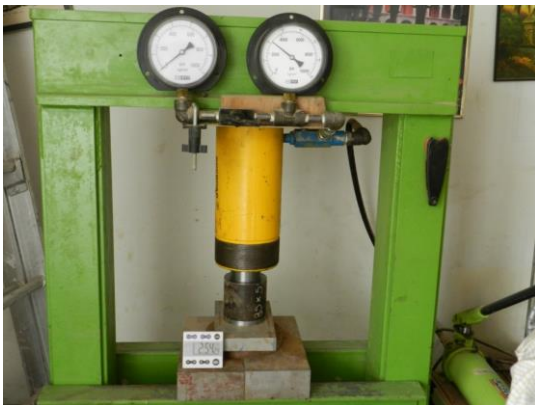
Fotografía 12. Celda sometida a presión (der), desarme y vaciado de celda (izq).
