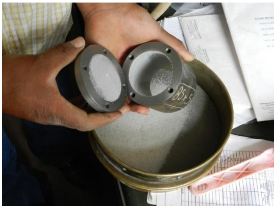
Fotografía 12. Celda sometida a presión (der), desarme y vaciado de celda (izq).
