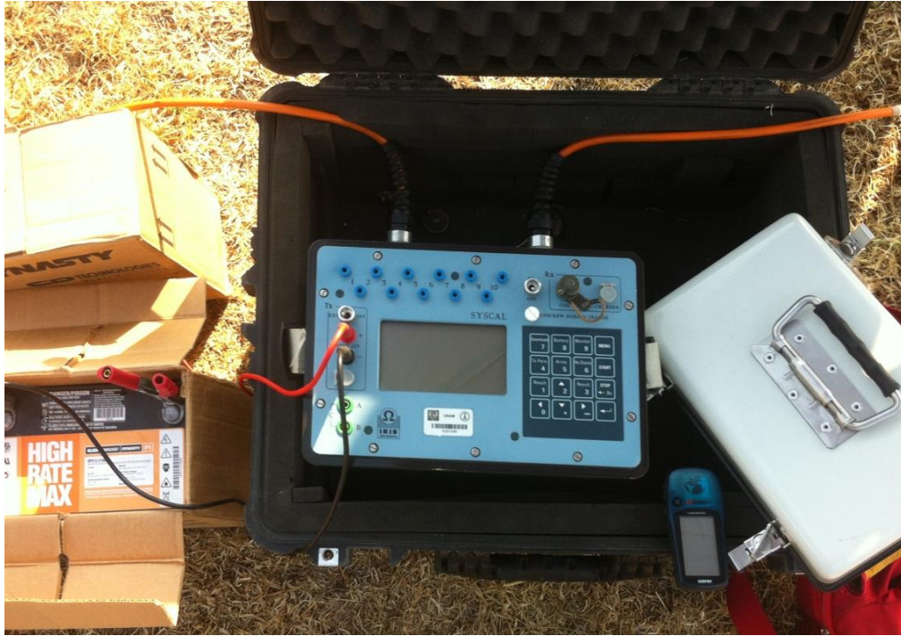
Figura 4.2. Equipo SYSCAL Pro Switch de Iris Instruments
