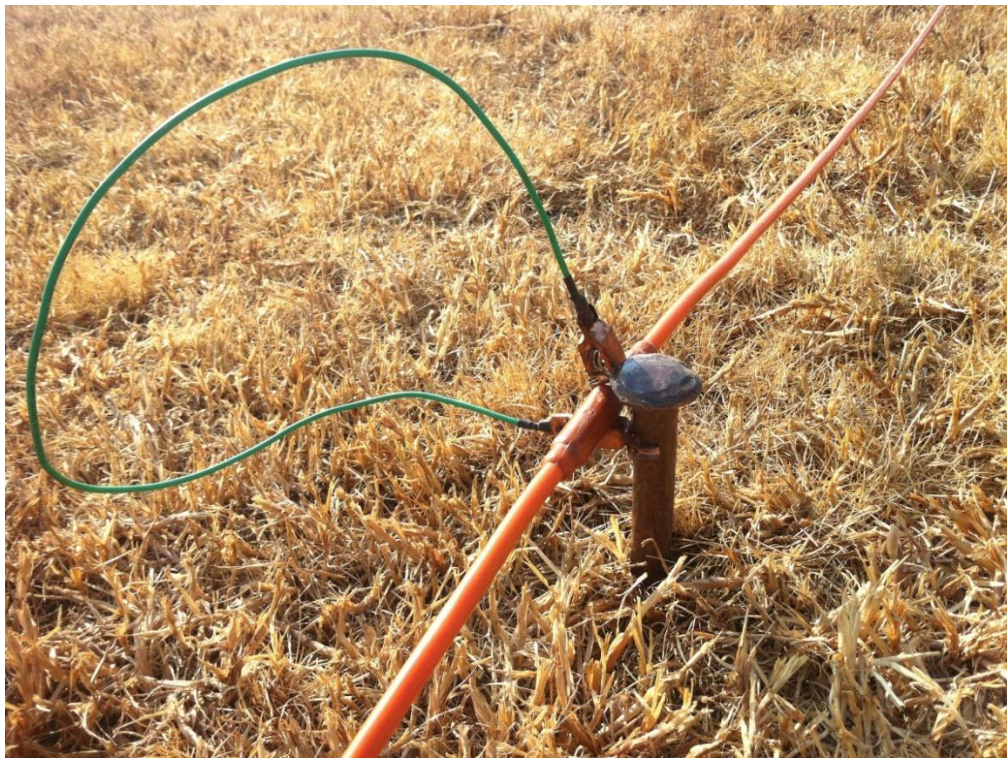
Figura 4.3. Conexión del electrodo al terreno
