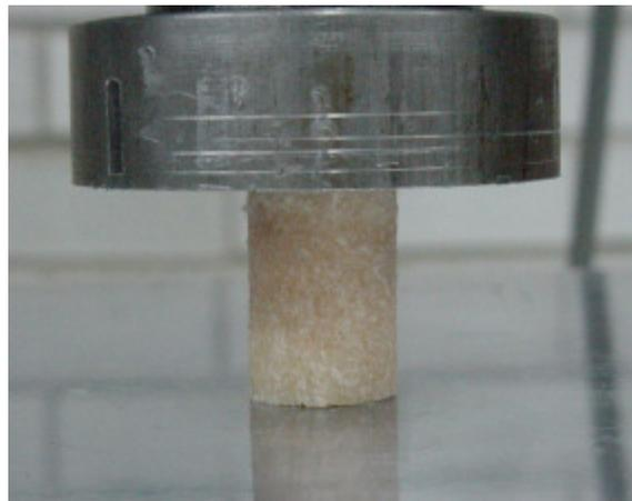
Fig 2.2. Ensayo de compresión para muestra ósea [16].
