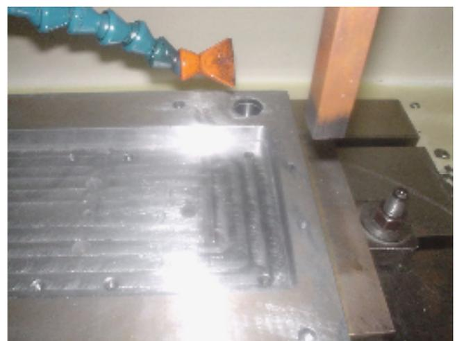
*Figura 2.21. Electroerosión de la placa móvil para encuadrar los contornos para colocar los moldes intercambiables.*
