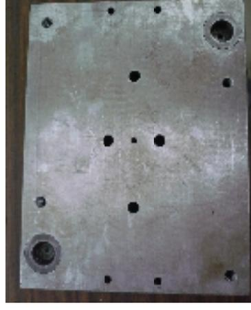
Figura 2.6. Camisas de pernos guía ensamblados.
