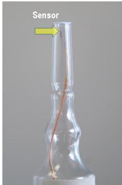
Figura 22. Colocación del sensor en la punta de la ampolleta.
