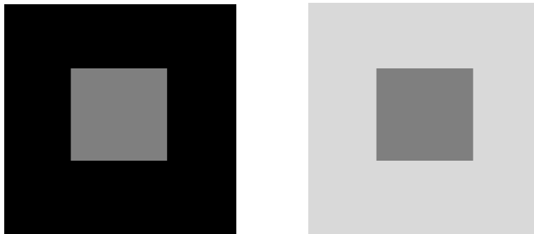
Figura 4.3 Ejemplo de la característica número 2 del sistema visual humano. El brillo absoluto de los cuadrados interiores es el mismo.
