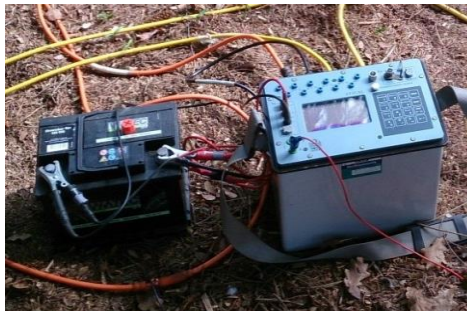
Figura 4.1.6.- Batería de alimentación.
