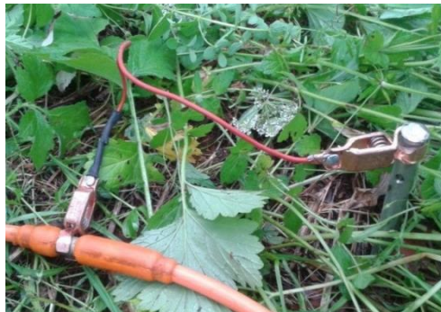
Figura 4.1.4.-Detalle de conectores utilizados para la conexión entre el cable multicore con los electrodos.
