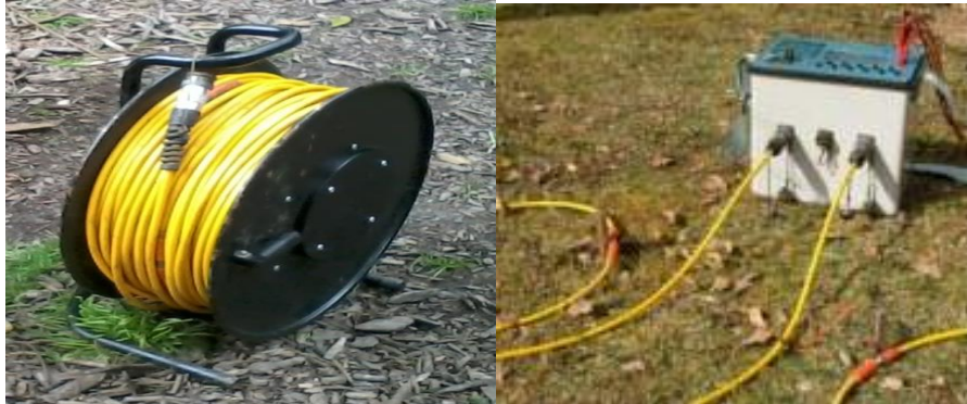
Figura 4.1.3.-Cables multicore utilizados en campo.
