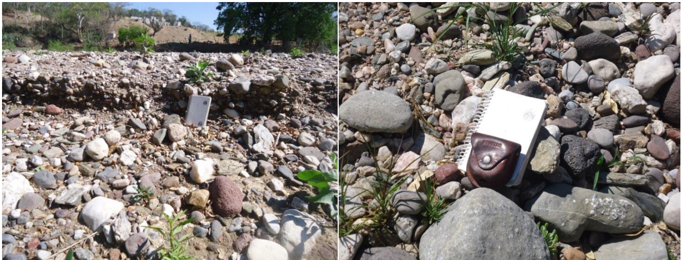
Figura 3.4.1.- Material aluvial depositado en el canal del Río Limón, se observa una composición de cantos rodados y gravas gruesas.
