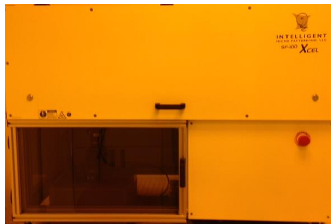
Figura 21 Fotografía de Sistema de fotolitografía libre de máscaras del laboratorio de BioMEMS y Lab on a Chip
