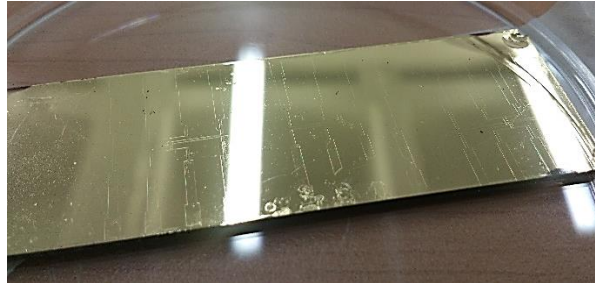
Figura 98 Depósito de oro en un sustrato con un patrón definido previamente en la resina Shipley 1827.
