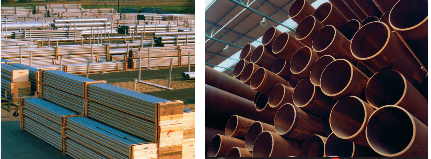
Figura 2.12 Tuberías de Acero al Carbono.
