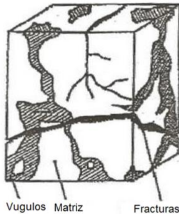
Figura 2.16 Visualización esquemática de la matriz, fracturas y vugulos de una roca de yacimiento.
