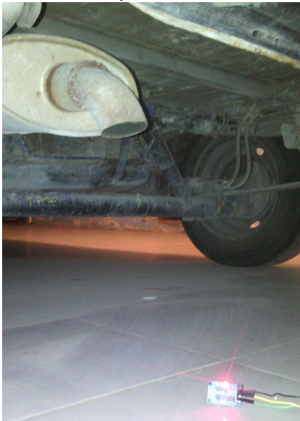
Figura 4.15 Lectura de contaminantes de un tubo de escape Tabla 4.1 Prueba ante distintas fuentes de contaminación
