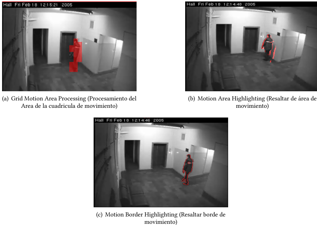
Figura 3.29 [Resultados para los distintos algoritmos de visualización para la de detección de movimiento] Recuperado de: http://www.aforgenet.com/framework/features/motion_detection_2.0.html
