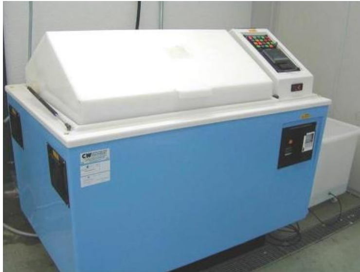
Figura 2.1 Cámara de origen comercial para la realización de ensayos con niebla salina.
