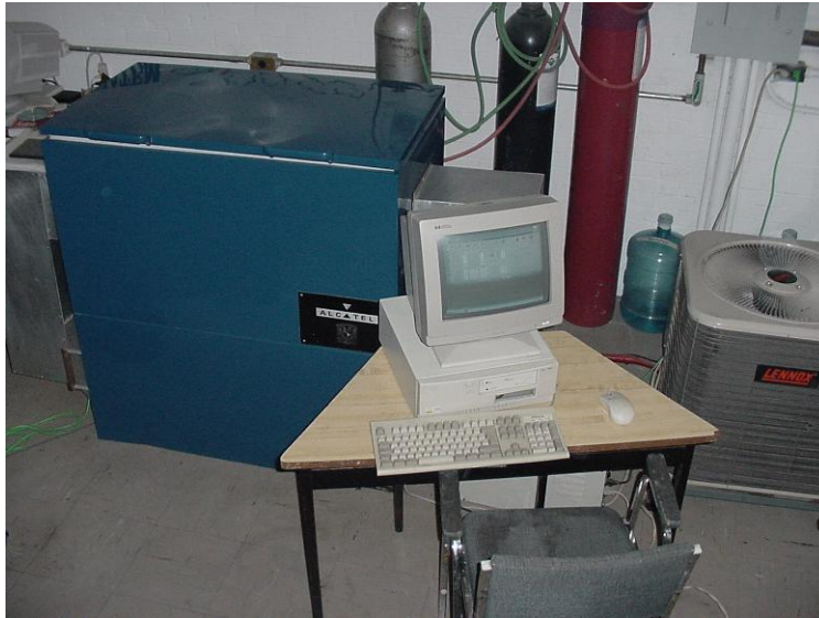
Figura 2.2 Cámara de Pruebas Aceleradas de Corrosión Atmosférica (CAPACA) diseñada por el grupo de trabajo de la UDIATEM [7].
