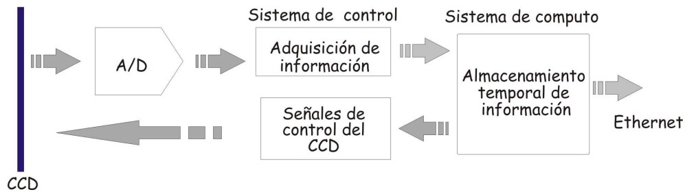
Figura 3.3: Esquema general del funcionamiento del sistema de adquisición.
