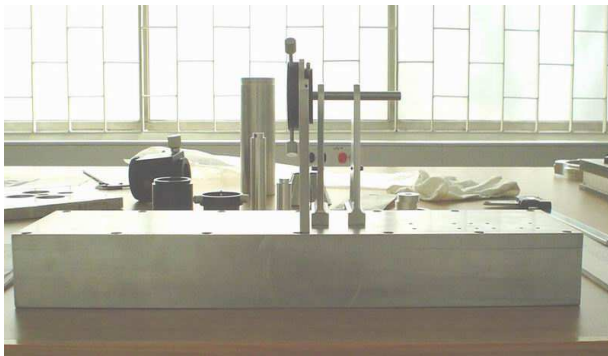
Figura 4.25: Montaje del diafragma de iris y los soportes de las ruedas de filtros y lentes
