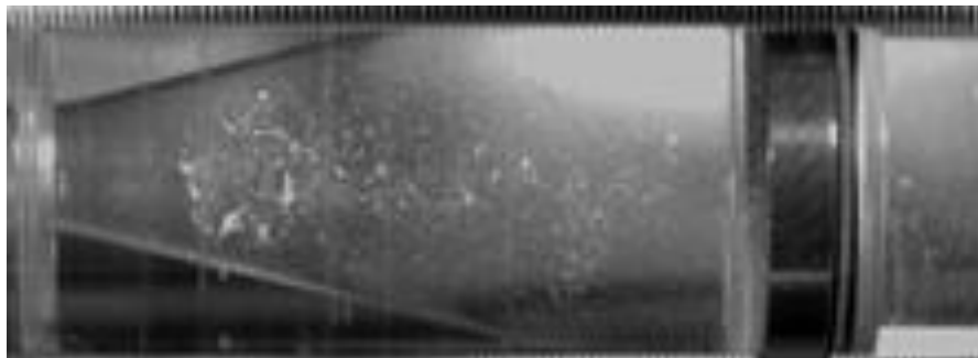
a). Fig. 45. Al 30 % cavitación en proceso.
