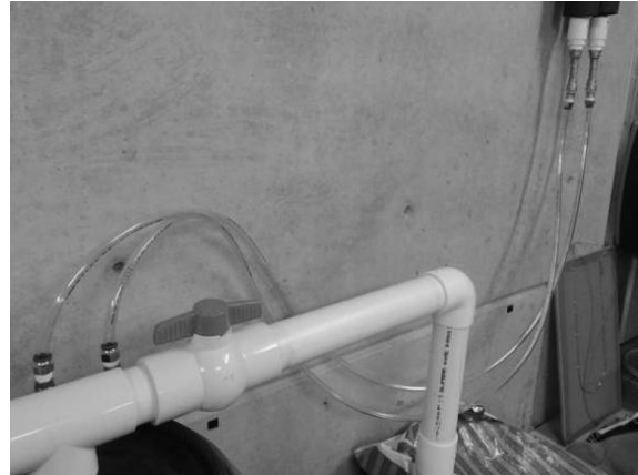
Fig. 17 Conexión del serpentin al sistema de enfriamiento
