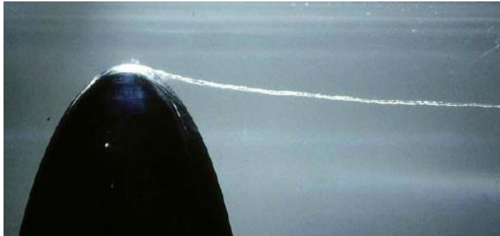
Fig. 9. Cavitación vórtice, generada por un hidrófilo tridimensional [17].
