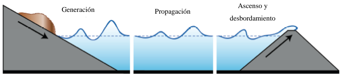
Figura 8. Etapas del fenómeno de deslizamiento de laderas en cuerpos de agua.
