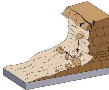
Figura 3. Movimiento de caída de bloques.
