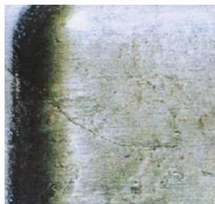
Figura 3.3 Defecto de flujo frío [1].
