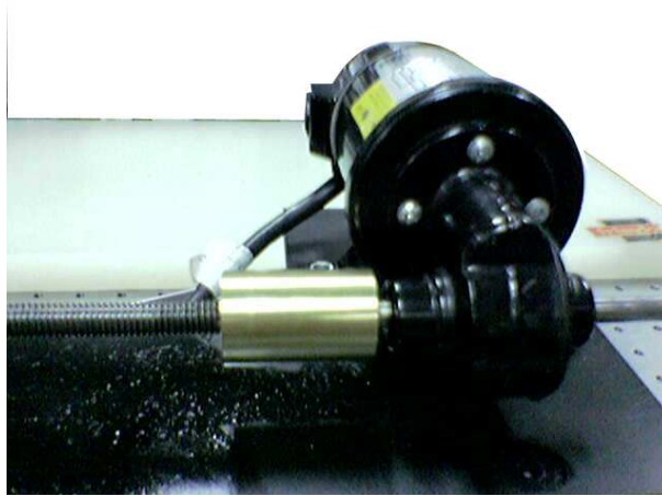
Figura 2.8: Fotografía del motor insertado en el arreglo pistón-cilindro
