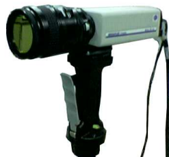
Figura 2.10: Fotografía de la cámara CCD
