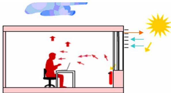
Imagen 9. Espacio único de entrada y salida de aire
