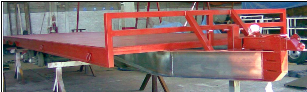
Fig. 4.37 Remolque con la etapa de aplicación de primario concluida.
