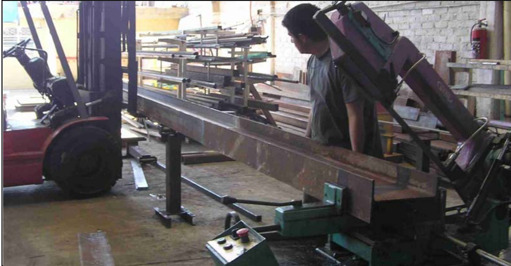
Fig. 4.21 Vigueta de carga en proceso de corte
