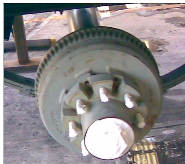
Fig. 4.35 Partes cubiertas con cinta
