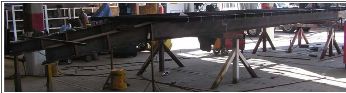
Fig. 4.26 Chasis con travesaños ensamblados.
