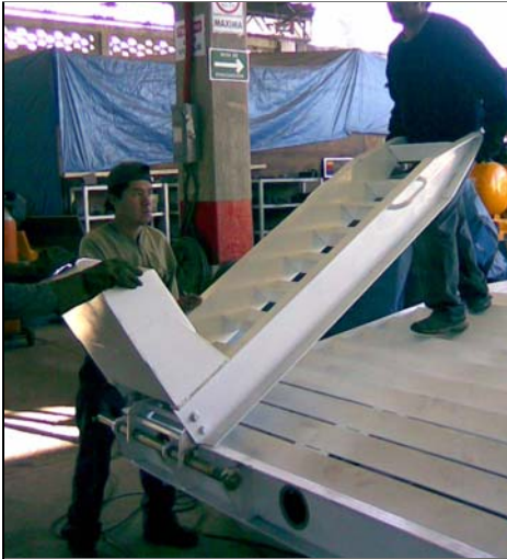
<<< Fig. 4.42 Prueba de giro de rampas.
