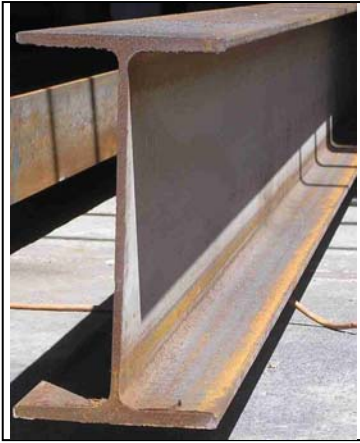
<<< Fig. 4.8 Vigueta tipo IPR de 12" x 6 ½" y 38.7 [kg/m]
