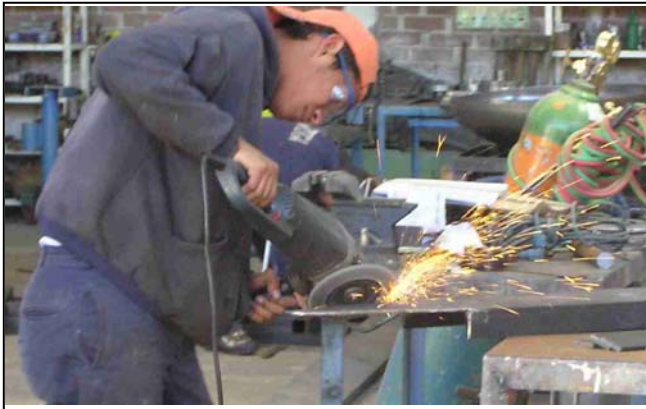
<<< Fig. 4.18 Trabajo de eliminación de rebaba con esmeriladora
