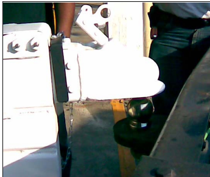
Fig. 4.43 Enganche a punto de acoplarse con la bola. >>>
