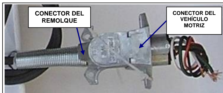
Fig. 3.30 Conectores de remolque y de vehículo motriz.
