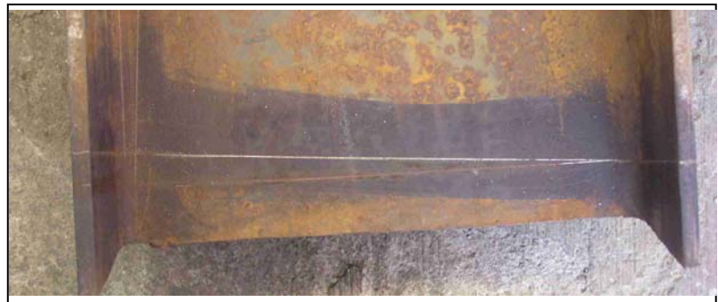
Fig. 4.9 Trazado para cortes de la vigueta >>>
