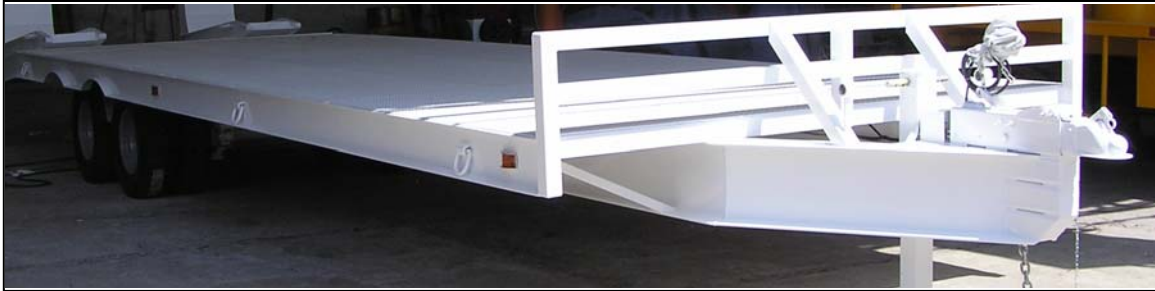
Fig. 4.39 Proceso de pintura concluido con la segunda capa aplicada.
