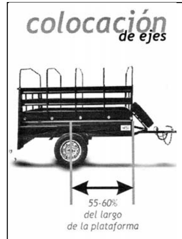
Fig. 3.3 Colocación correcta de los ejes del remolque. >>>
