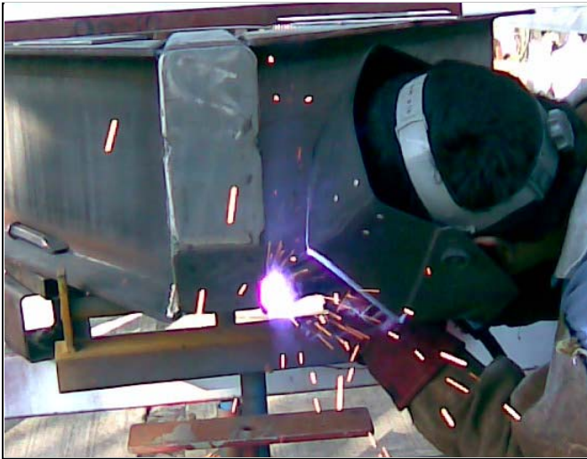
Fig. 4.24 Detalle de soldadura para unir base de tirón.
