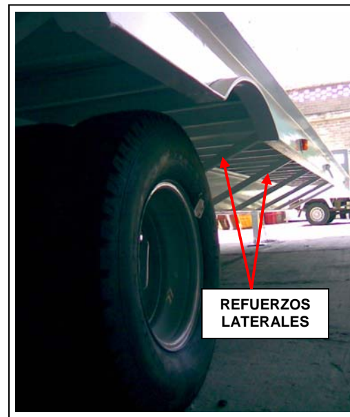
Fig. 2.6 Parte inferior del remolque con nuevos refuerzos laterales. >>>
