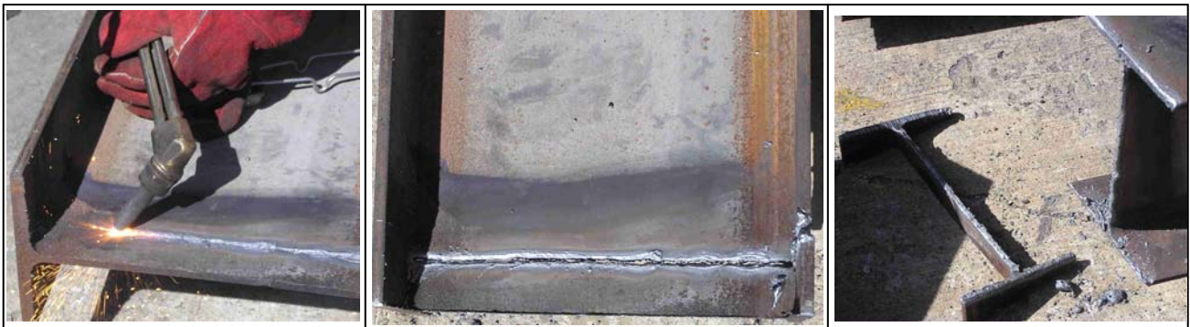
Fig. 4.10 Proceso de corte con equipo de oxicorte.
