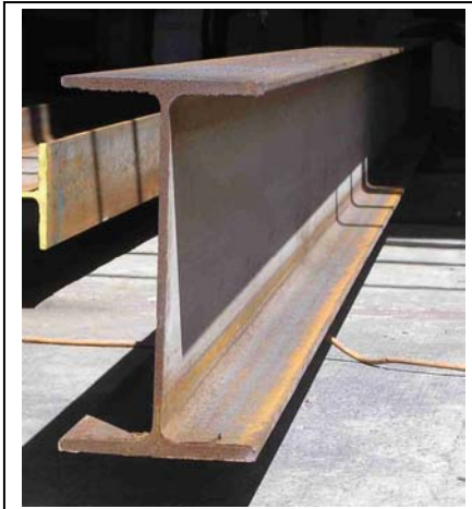
Fig. 2.4 Vigueta tipo IPR de 12" x 6 1/2" de 38.7 kg/m
