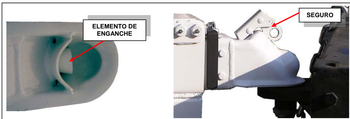
Fig. 3.33 Detalle de tirón hidráulico.
