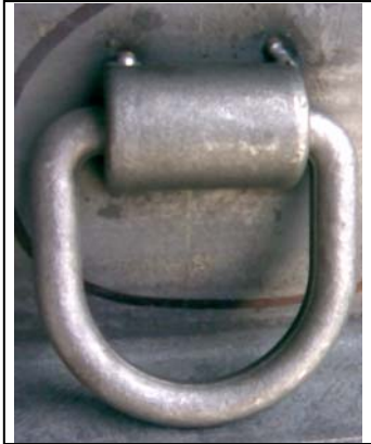
<<< Fig. 3.34 Anillo en “D” soldado al remolque
