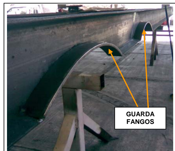
Fig. 2.3 Canal de 8'' de 17.11 kg/m con cortes y guarda fangos.
