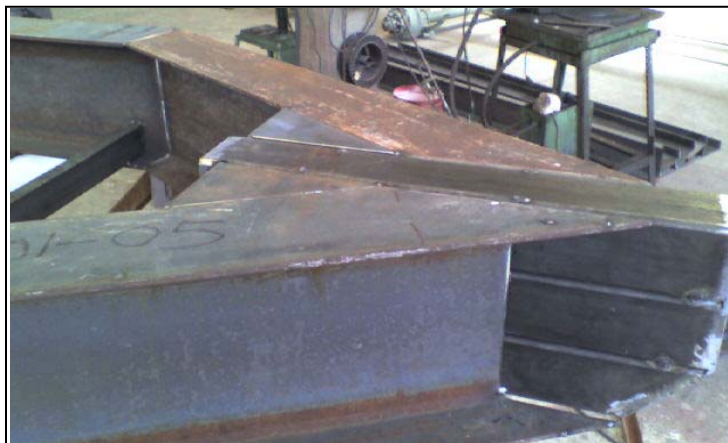
Fig. 4.25 Base de tirón ensamblada en el chasis.
