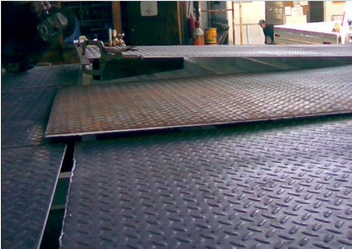
<<< Fig. 4.32 Detalle del ajuste de las placas para el piso de la cama
