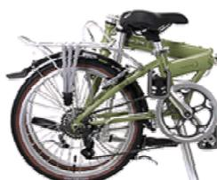
Figura 38. Ej. de plegado mediante bisagra a la mitad del cuadro.
