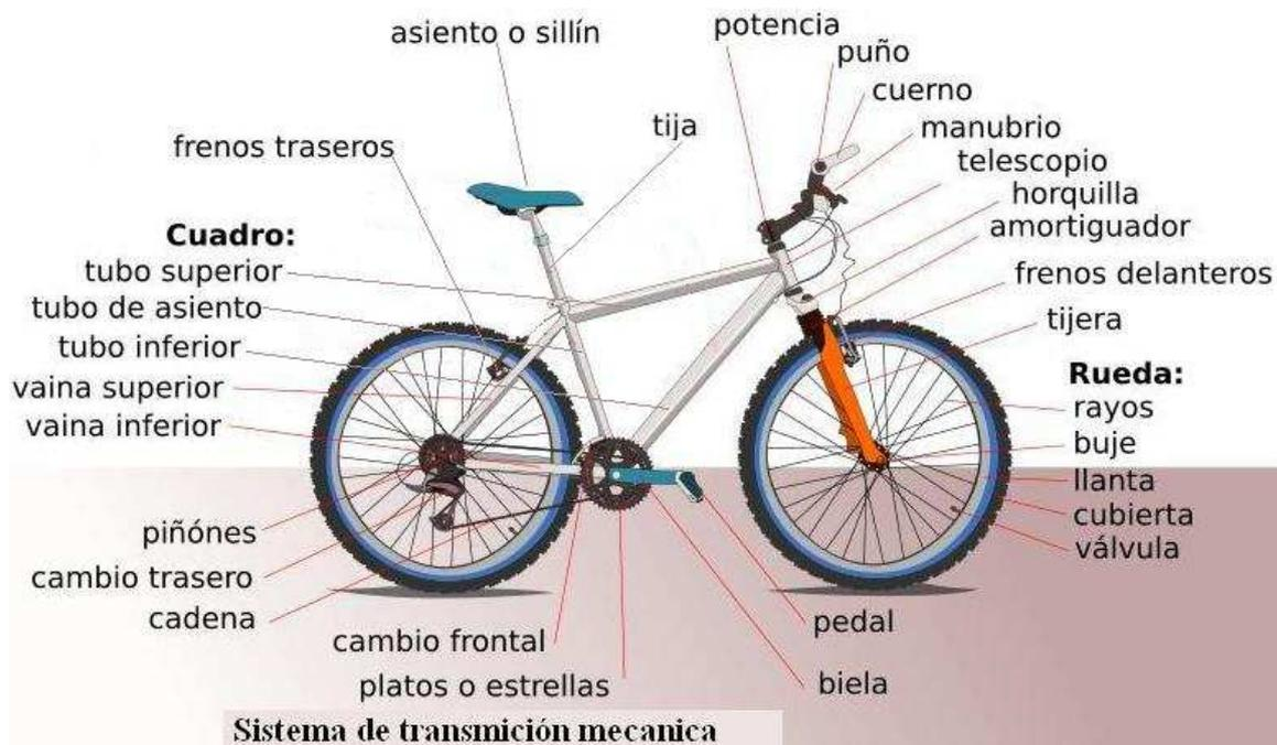
Figura 11. Sistemas y componentes básicos de la bicicleta. [15]
