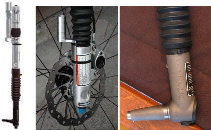
Figuras 51. Horquillas delanteras Cannondale - Lefty para llanta rodada 26.
