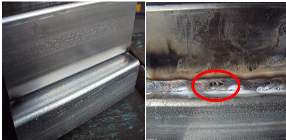
Figura 4.6 Resultado de la unión de acero galvanizado e inoxidable.
