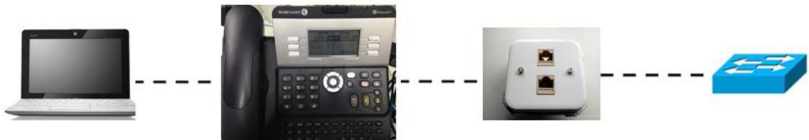
Imagen 15. Conexión Física del equipo de VoIP
