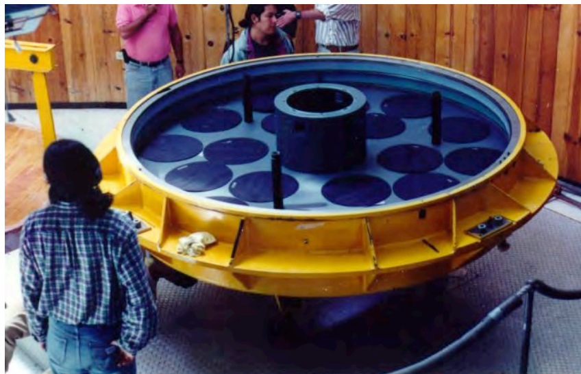
Figura 3-2. Soporte activo del espejo 2.1m en el OAN/SPM donde se pueden apreciar las bolsas neumáticas empleadas para alinear y corregir las deformaciones por peso propio {6}.
