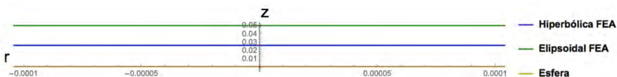
Figura 9-4. Detalle de los desplazamientos en el vértice de cada superficie. Unidades mm.
