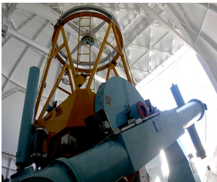
Figura 2-3. Fotografía del telescopio de 2.1m del OAN/SPM, donde se puede apreciar la estructura de telescopio y su montura de tipo ecuatorial.
