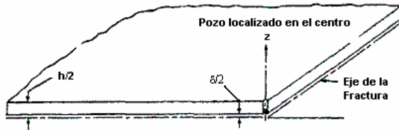
Figura I.2. Idealización de un Yacimiento Fracturado hecha por Kazemi, en la cual se muestra una sección representativa del yacimiento
