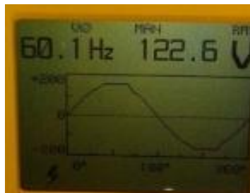
Figura 4.13 “Forma de onda de voltaje medido caso 3”
