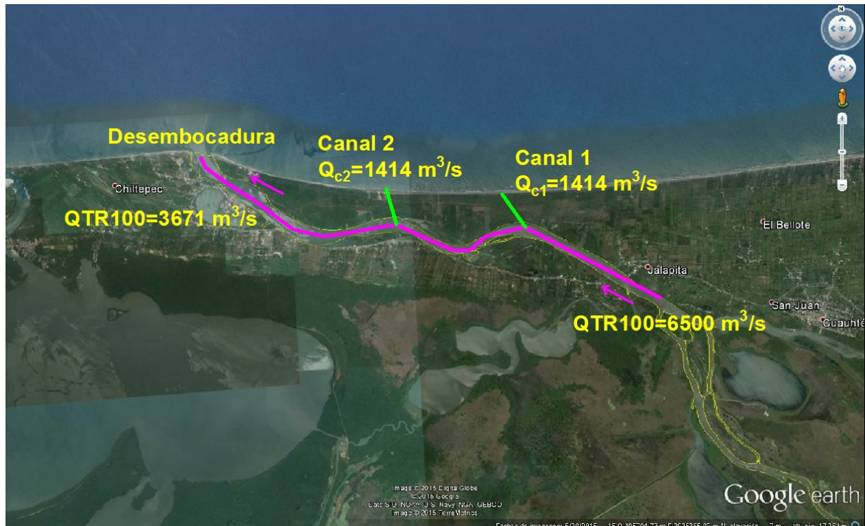
Figura 4.1 Esquema del balance hidráulico de la zona costera con los dos canales de desvío funcionando
