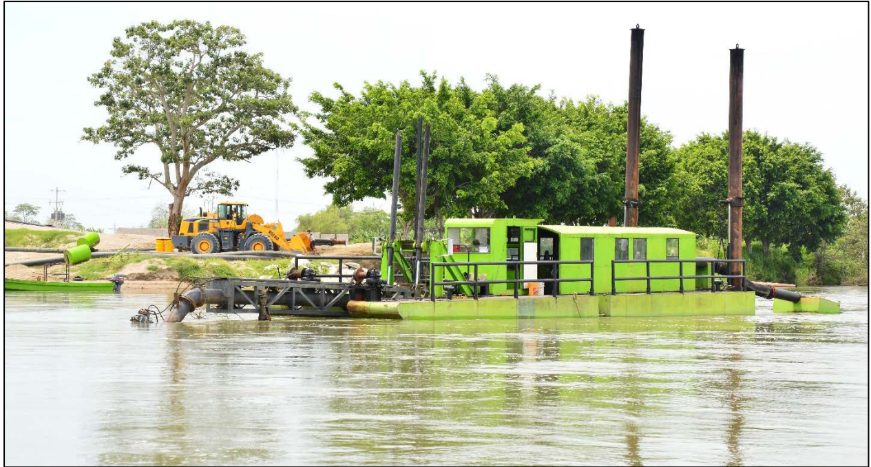
Figura 5.11 Draga mecánica presente en el río Samaria. Fuente: Instituto de Ingeniería, 2014.
